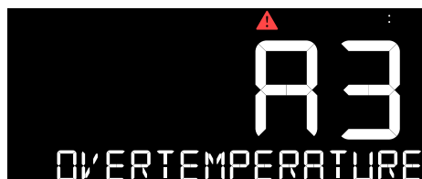
Fig. 39: Exemple : alarme de surchauffe A3 active
